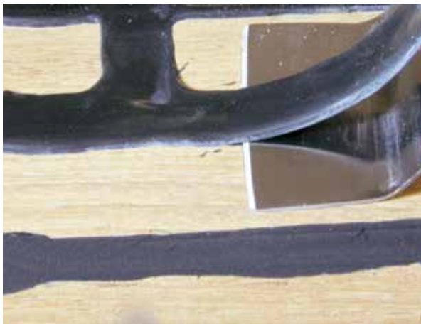
Abb. 48: Entfernen von überschüssigem 290 DC PRO mit einem oszillierenden Schaber
