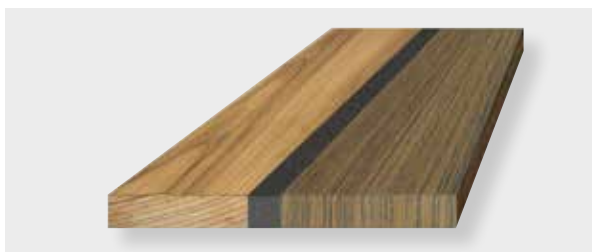
Abb. 24: Links liegende Jahresringe (nicht empfohlen), rechts stehende Jahresringe (empfohlen)
