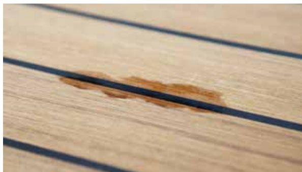
Abb. 36: Beschädigtes Teakdeck durch Wassereintrich
