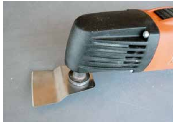
Abb. 44: Nützliches und effektives Werkzeug zum Auskratzen der Dichtfugen
