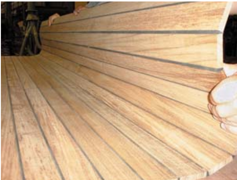
Abb. 5 Vorgefertigtes Teakdeck aus Stabdeckleisten mit beachtlicher Festigkeit und Elastizität
